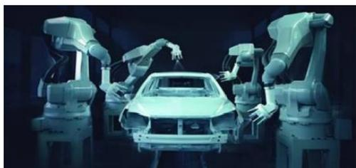
**涂装工艺**采用全封闭无尘、无毒、无害车间，使用喷涂机器人操作，采用睡醒环保油漆。机器人使用ABB、
